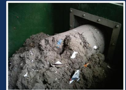
Durch die kontinuierliche Staubaustragung aus der Filteranlage minimiert sich das Risiko einer Staubexplosion im Filter. Entscheidend ist dabei auch, dass der Filtertrichter nach der Abreinigung der Filteranlage komplett leer ist, sodass beim Wiedereinschalten kein Staub mehr aufgewirbelt wird und damit keine explosionsfähige Atmosphäre entstehen kann.
